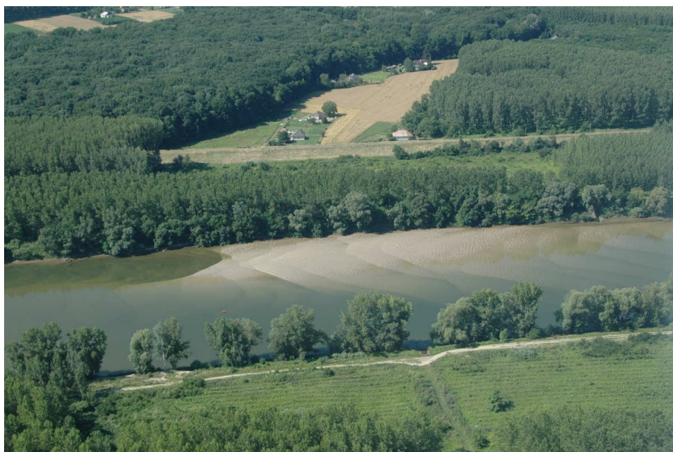
Obr. č. 3 a 4 Foto úseku pri vyústení Nitry a pri Zemnom rkm 35-32- zřejmé intenzívne nánosy v koryte
